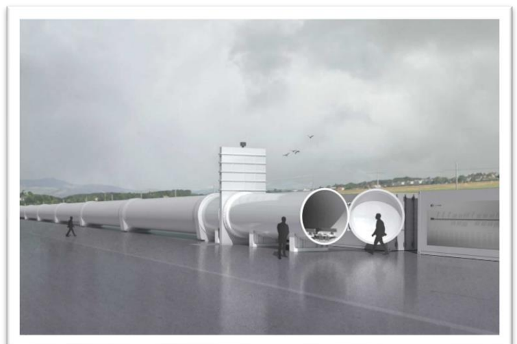
Visualisierung der 120 Meter Vakuumröhre aus Beton mit Schleuse aus Stahl. Geplant per Ende 2025.
